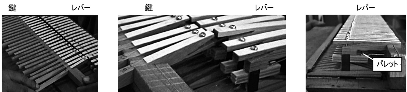
図5 レバー型鍵盤の仕組み(左・中央は鍵とレバー、右はレバーの断面図)
